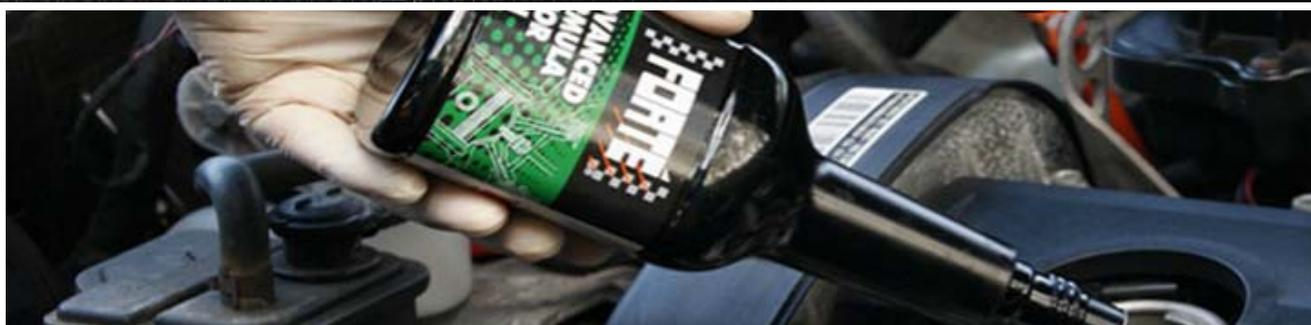
Se incorpora 2 botes de Forté Motor Flush al cárter de aceite. Se trata de un vehículo al que nunca se le ha realizado una limpieza al sistema de lubricación. Se añade un bote de Forté Gas Treatment al depósito para limpiar el sistema de Combustión, y se rueda el vehículo durante 30 minutos.
